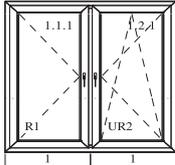
2 fig. Fenster D/DK - Setzpfosten
